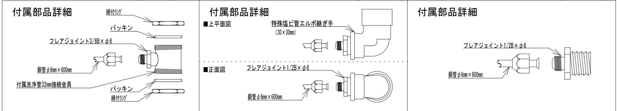
■当社の小型温水器に膨張水排出装置 (TR-2) を接続してご使用の場合、上記の3種類の付属品より1種類を選択できます。設置例を参考にして、現場の用途に合わせてご選択下さい。(チェック欄に  または、 をして下さい。)
