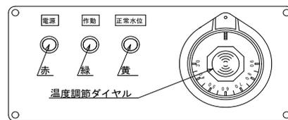
注：DEタイプの場合は正常水位ランプがありません。機器の中央の水位計にて水位を確認して下さい。
