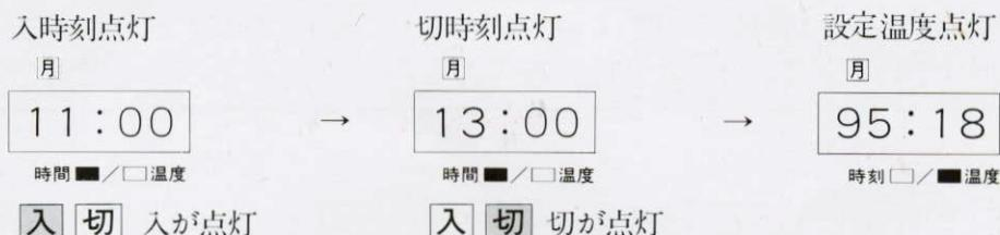
以上のように、1ステップ→2ステップ→3ステップ→4ステップと、順に表示されます。このとき、例えば1ステップだけしかプログラムされていないときは、2~4ステップの表示は0000になります。
